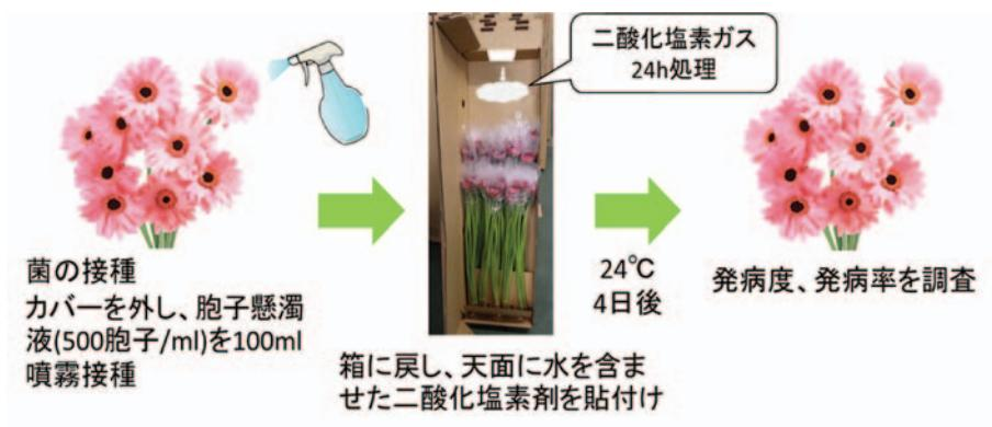
図 11 ガーベラにおける二酸化塩素剤処理輸送試験方法
