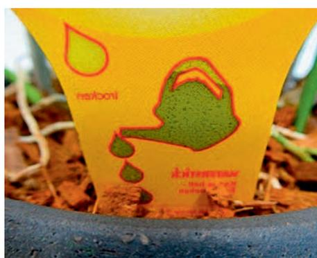
画像 1 鉢に差し込んだ状態の PF メーター 画像 2 簡易土壤水分計の表示部分
